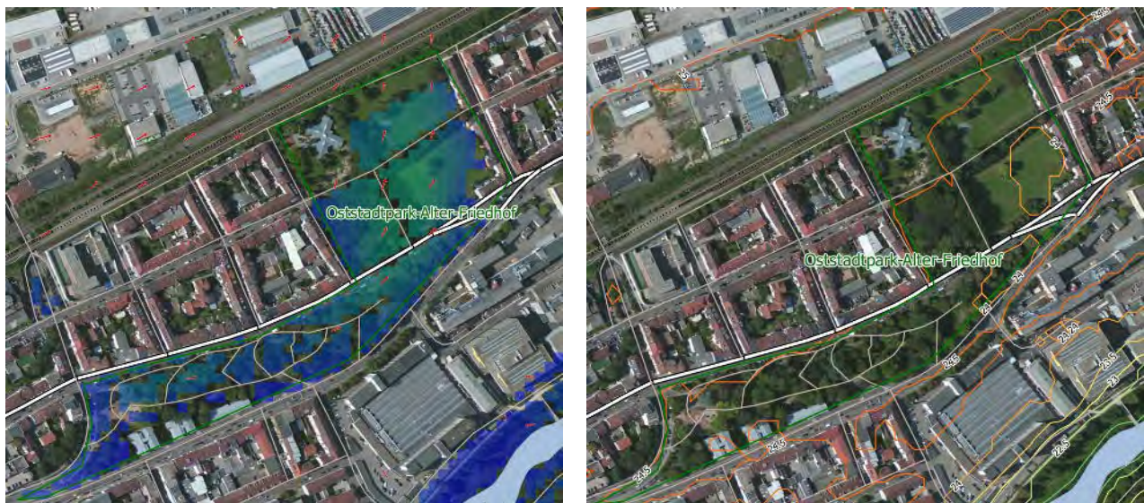
Abb. 8-7: Strömungs- und Temperaturverhältnisse im Bereich des Oststadtparks – Alter Friedhof zu Beginn der Nacht. In der linken Abbildung ist neben den Strömungspfeilen die Intensität des Kaltluftvolumenstroms dargestellt (zunehmende Intensität von blau über grün zu rot).
