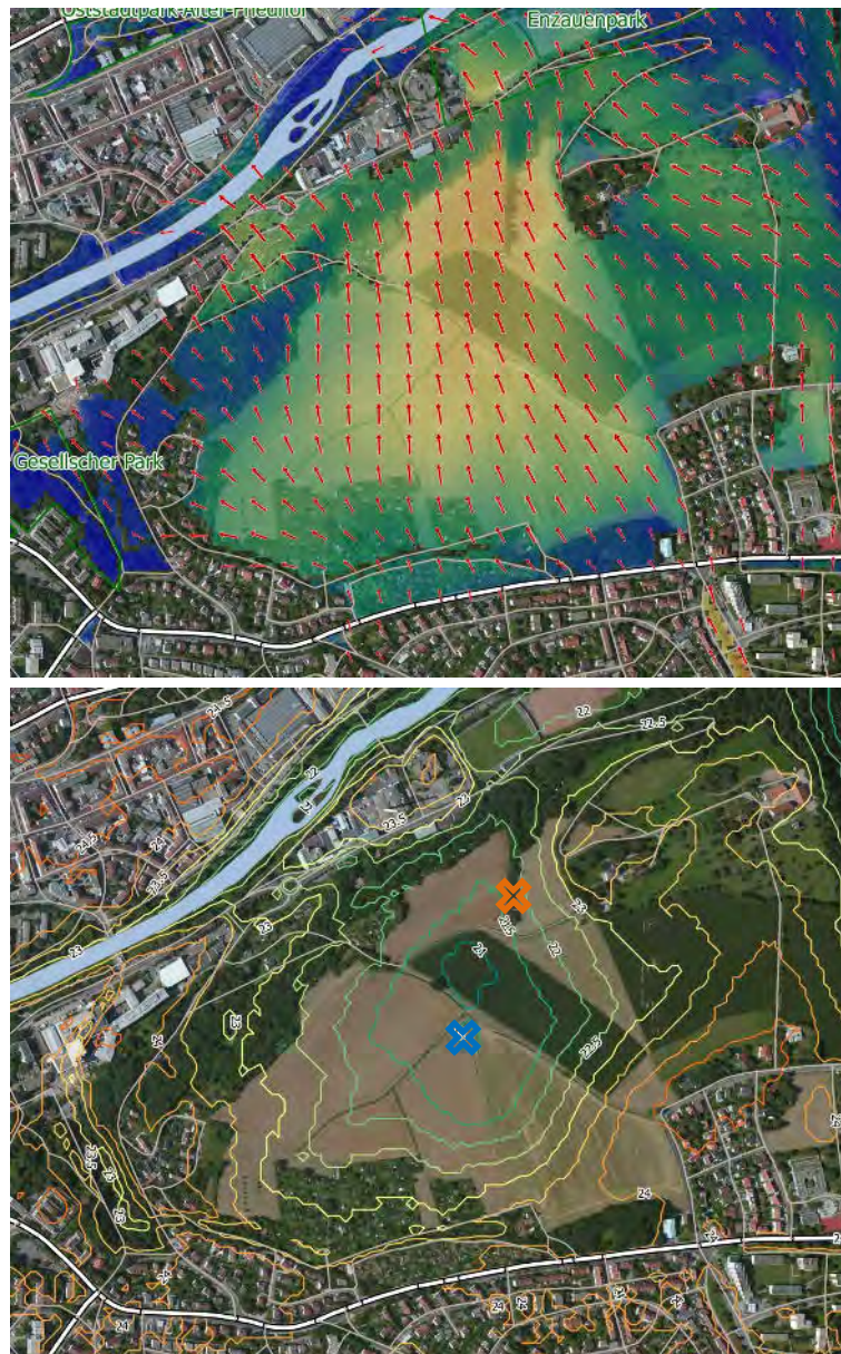
Abb. 8-24: Strömungs- und Temperaturverhältnisse im Bereich Buckenberg zu Beginn der Nacht. In der oberen Abbildung ist neben den Strömungspfeilen die Intensität des Kaltluftvolumenstroms dargestellt (zunehmende Intensität von blau über grün zu rot). Die Kreuze kennzeichnen die Standorte der Temperaturmessungen von Abb. 8-23.
