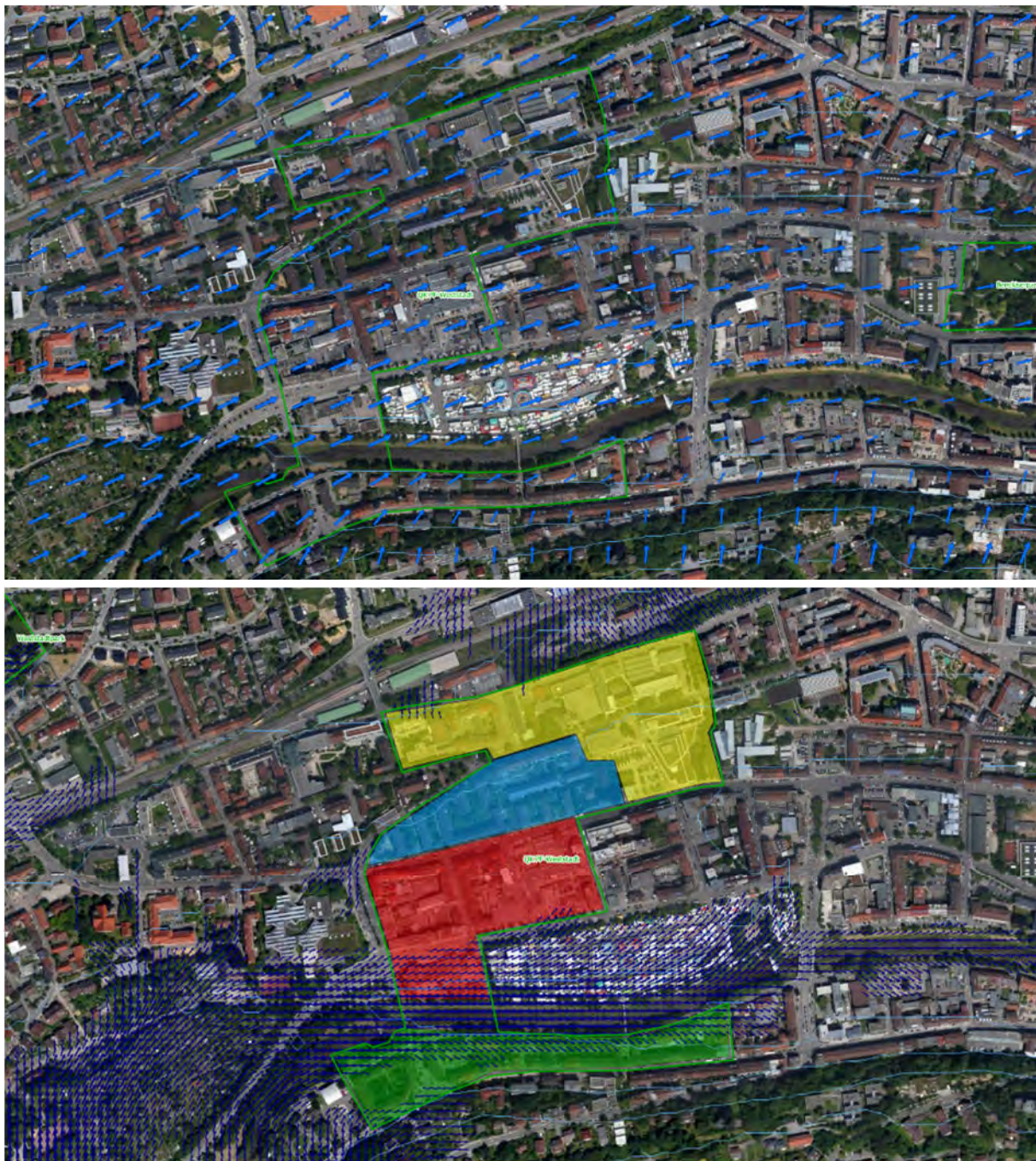
Abb. 9-7: Strömungsverhältnisse im Sanierungsgebiet Weststadt. Strömung im Überdach-Niveau (oben) und in Bodennähe (unten).
