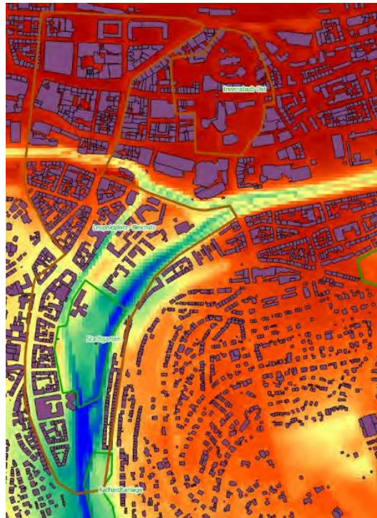
Abb. 9-24: Temperaturverteilung im Bereich Leopoldstraße/Bleichstraße während einer nächtlichen autochthonen Wetterlage. Kühle Temperaturen sind mit Grüntönen, hohe mit roten Farben verbunden.
