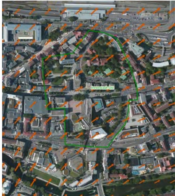
Abb. 9-42: Strömungsverhältnisse im Plangebiet Innenstadt Ost. Strömung im Überdach-Niveau.
