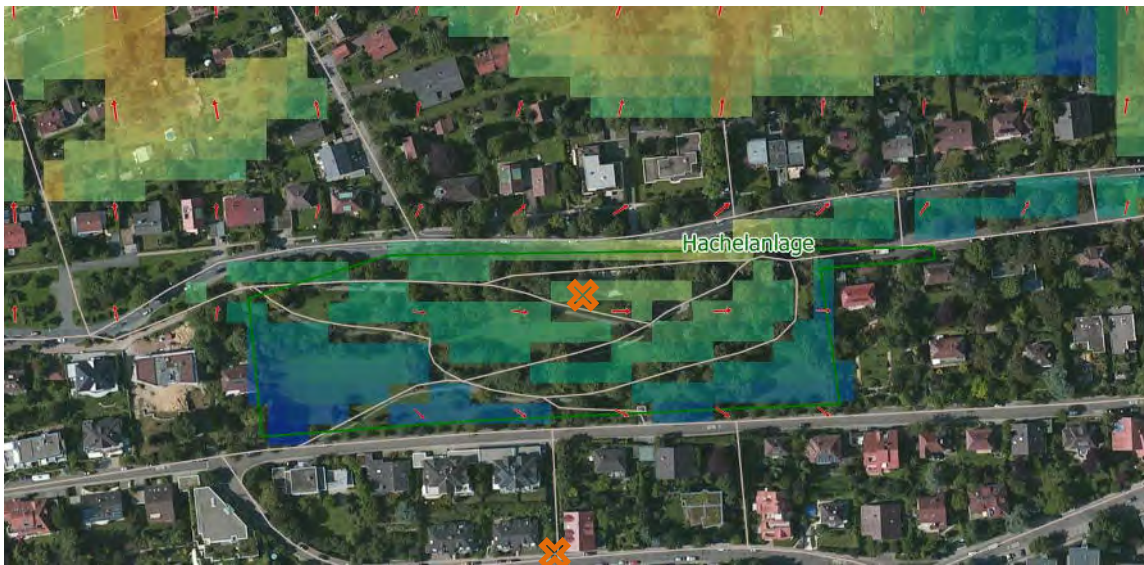
Abb. 8-19: Strömungs- und Temperaturverhältnisse im Bereich der Hachelanlage zu Beginn der Nacht. In der Abbildung ist neben den Strömungspfeilen die Intensität des Kaltluftvolumenstroms dargestellt (zunehmende Intensität von blau über grün zu rot). Die Kreuze kennzeichnen die Standorte der Temperaturmessungen von Abb. 8-21.
