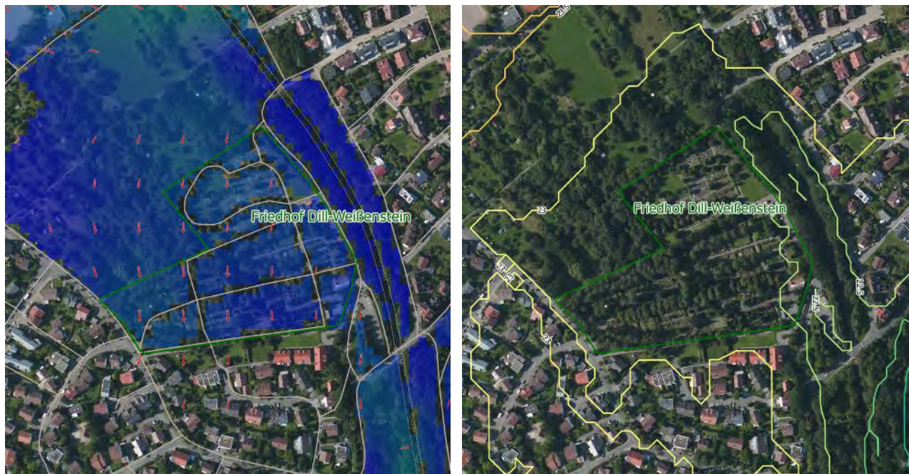
Abb. 8-14: Strömungs- und Temperaturverhältnisse im Bereich des Friedhofs Dill-Weißenstein zu Beginn der Nacht. In der linken Abbildung ist neben den Strömungspfeilen die Intensität des Kaltluftvolumenstroms dargestellt (zunehmende Intensität von blau über grün zu rot).
