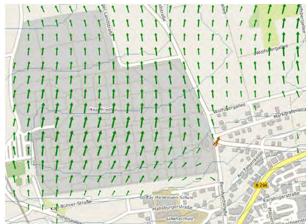
Abb. 6-10: Berechnete Strömung (grüne Pfeile) in Bodennähe zu Beginn der Nacht und Strömungsrichtung abgeleitet aus Rauchversuchen und Windmessungen (restliche Pfeile).
