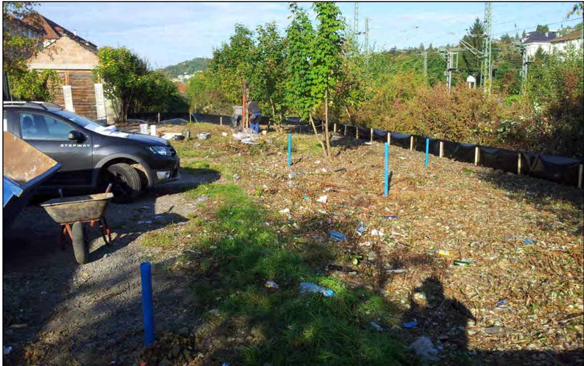
Foto 9: Bohrstellen Rammkernsondierungen 2014 (blaue Rohre). Das Bohrgerät steht bei RKS 2014-1).
