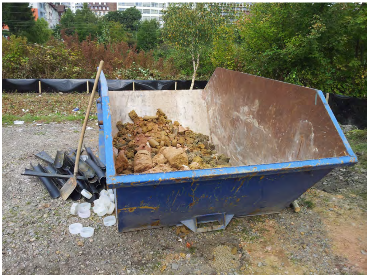
Foto 10: Mulde mit Bohrgut; links die geöffneten Liner
